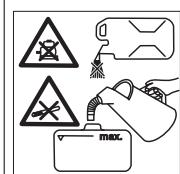
Não abastecer com o motor em funcionamento.
