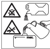
Не заправлять топливо при работающем двигателе.
