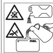
Ikke fyll på tanken med motoren i gang. Ikke røyk ved tanking. Ikke fyll på tanken direkte fra kassen, bruk en trakt eller en egen beholder.
