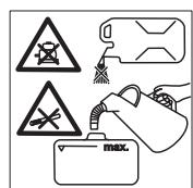
وفقاً للقواعد السارية يحظر تشغيل الجهاز مطلقاً بدون وجود فاصل النظام بشبكة مياه الشرب. يجب استخدام فاصل النظام الملاorman الذي تتوجه شركة KARCHER أو بدلاً منه يستخدم فاصل نظام وفقاً للمعيار EN 12729 من الفتة BA.
